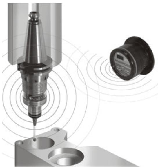
大型加工中心和五轴加工中心以及大型车削中心均需要拥有大范围传输的测头, 这种要求通过**无线电传输技术**可以实现。
