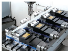
▲采用标准并列方法实现长尺寸工件的安定精度加工
